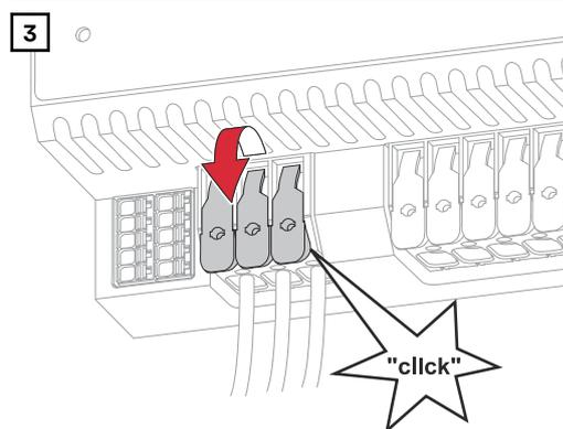
Die Betätigungshebel der Anschlussklemmen bis zum Einrasten schließen.
