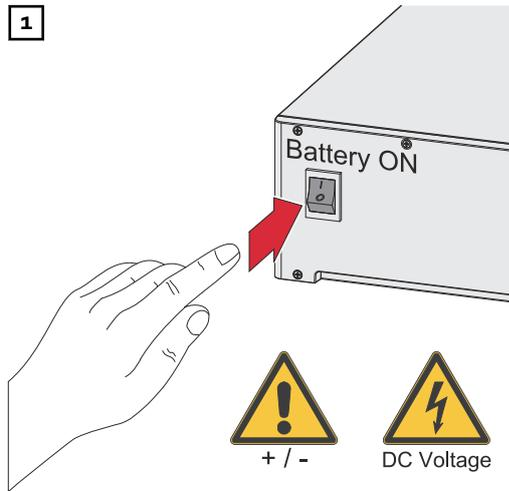
Die am Wechselrichter angeschlossene Batterie einschalten.
