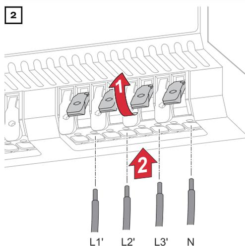
Die Betätigungshebel der Anschlussklemmen durch Anheben öffnen. Die abisolierten Einzelleiter in den jeweils vorgesehenen Steckplatz bis zum Anschlag in die Anschlussklemme stecken.
