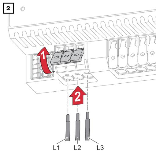
Die Betätigungshebel der Anschlussklemmen durch Anheben öffnen. Die abisolierten Einzelleiter in den jeweils vorgesehenen Steckplatz bis zum Anschlag in die Anschlussklemme stecken.
