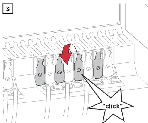
Die Betätigungshebel der Anschlussklemmen bis zum Einrasten schließen.
