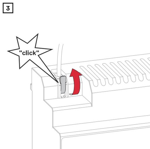
Den Betätigungshebel der Anschlussklemme bis zum Einrasten schließen.
