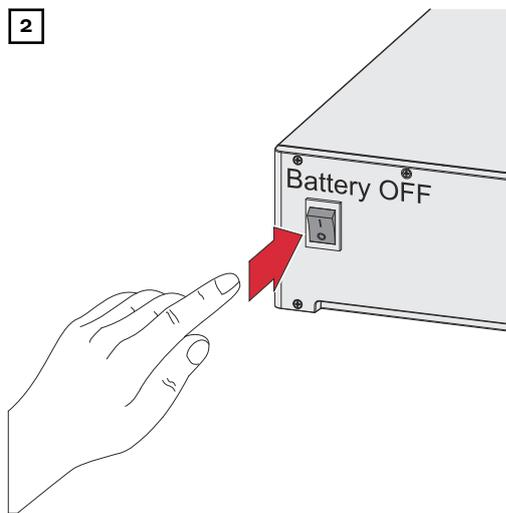
Die am Wechselrichter angeschlossene Batterie ausschalten.
