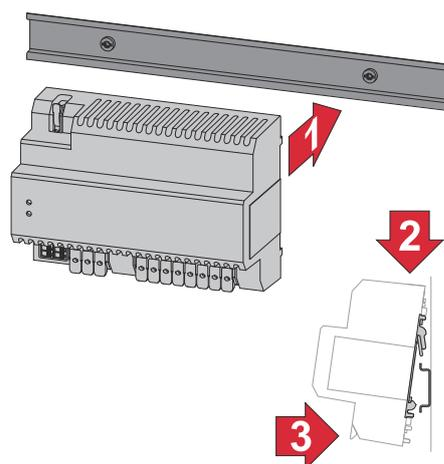
Der Fronius Backup Controller kann auf einer DIN-Hutschiene 35 mm montiert werden. Das Gehäuse hat eine Abmessung von 8 Teileinheiten (TE) gemäß DIN 43880 und die Baugröße 2.
