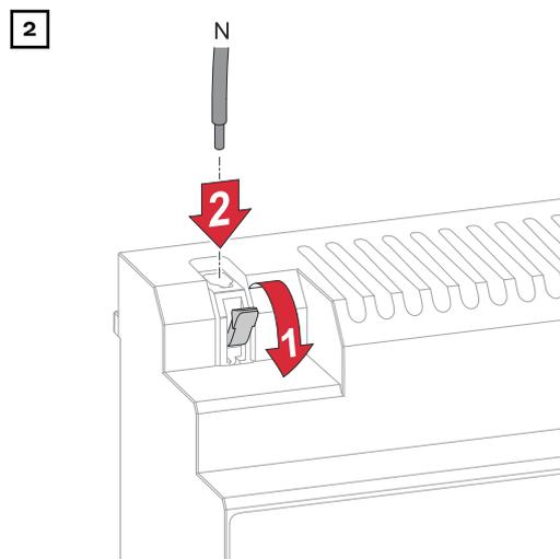
Die Betätigungshebel der Anschlussklemmen durch Anheben öffnen. Den abisolierten Einzelleiter in den vorgesehenen Steckplatz bis zum Anschlag in die Anschlussklemme stecken.
