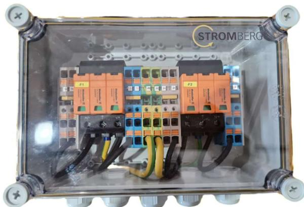
PV STROMBERG Generatoranschlusskästen für Wechselrichter mit 1 bis 10 MPP-Trackern werden zum Schutz der DC-Seite einer Photovoltaikanlage eingesetzt. Die Generatoranschlusskästen schützen den Wechselrichter gegen Überspannungen und erfüllen damit die Europäische Richtlinie EN 51543-32. Zusätzlich bieten diese Produkte die Möglichkeit die Anlage gegen Rückströme zu schützen und die Möglichkeit Strings zu kombinieren, um bei der Installation Kabel einzusparen.
