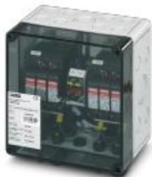
Generatoranschlusskasten für Photovoltaikanlagen bis 1000 V DC zum Anschluss von 2x 1 String. Mit Überspannungsschutz und SUNCLIX DC-Steckverbinder für die Eingangs- und Ausgangsseite.
